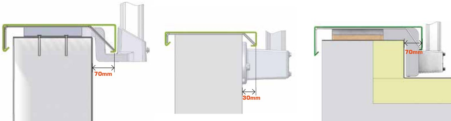
La scossalina sarà realizzata su misura, in funzione delle finiture interne ed esterne dei muri perimetrali (isolamento, impermeabilizzazione, rivestimento, ...)
